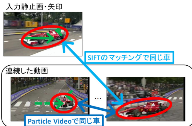
図 4:SIFT と Particle Video を個々で用いた静止画検索
