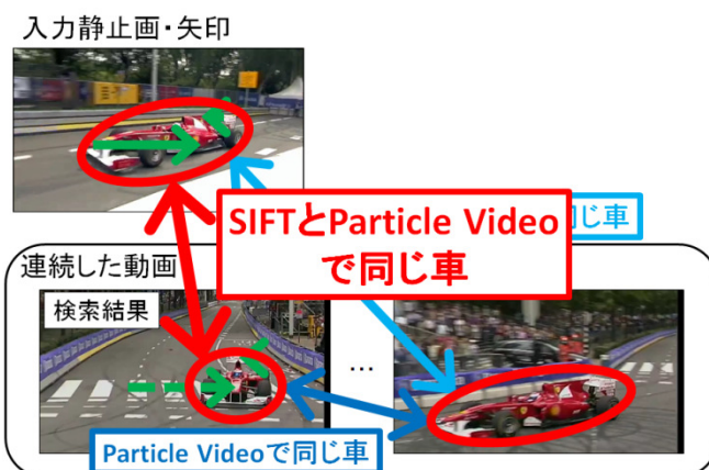
図 5:SIFT と Particle Video を同時に用いた静止画検索
