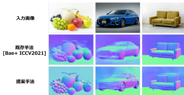
図 4 法線マップ推定器による写真画像の法線マップの推定の結果。既存手法よりも詳細で正確な法線を出力できる場合がある。
